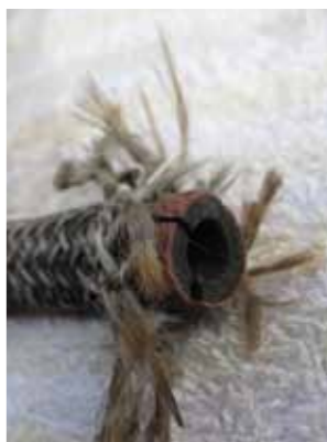
劣化した燃料ホース
