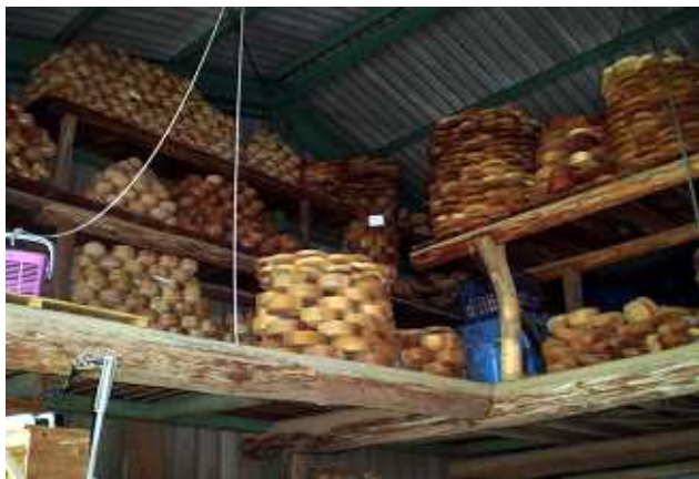
児玉工芸 乾燥棚での樹名板乾燥工程
