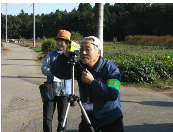
・タイトル：トゥルーパルスによる樹高測定 ・撮影者：増田 ・撮影月日：07.11.4
